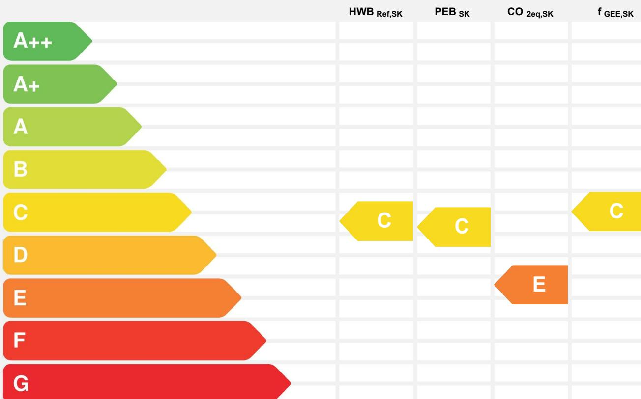
**HWB<sub>Ref</sub>**: Der **Referenz-Heizwärmebedarf** ist jene Wärmemenge, die in den Räumen bereitgestellt werden muss, um diese auf einer normativ geforderten Raumtemperatur, ohne Berücksichtigung allfälliger Erträge aus Wärmerückgewinnung, zu halten.
